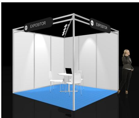
**Estrutura:** em alumínio anodizado cor natural, paredes em MDF laminado cor branco;
